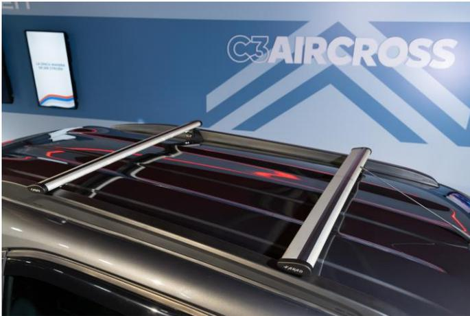
As barras de teto longitudinais tem apenas efeito estético. Porém no ano MY 24/25 foram colocados 4 suportes na estrutura do veículo que permitem a fixação de barras transversais MOPAR (oferecida como acessório) sobre esses suportes, possibilitando carga extra de 30 kg.
